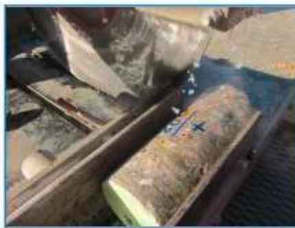
Foto 4 Taglio delle carote con lama diamantata
